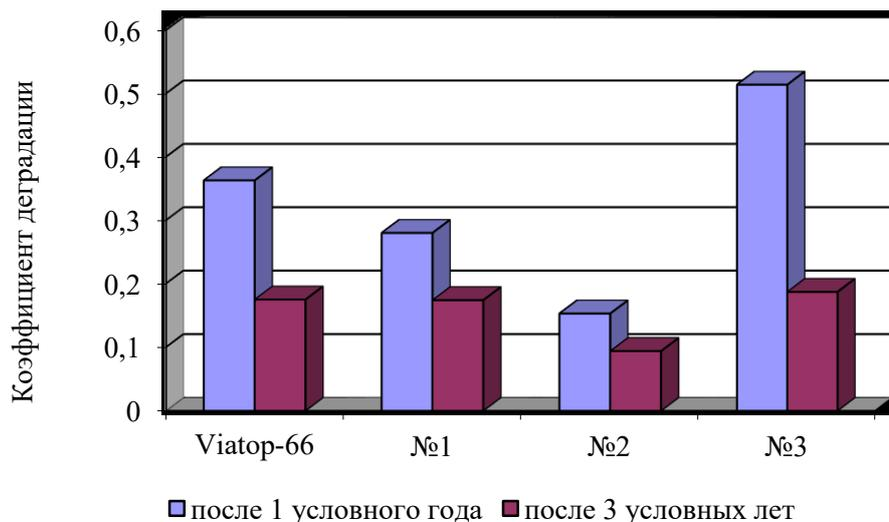
Рис. 1. Значения коэффициента дегградации для ЩМА с разными стабилизирующими добавками через 1 и 3 года моделирования погодно-климатического воздействия
