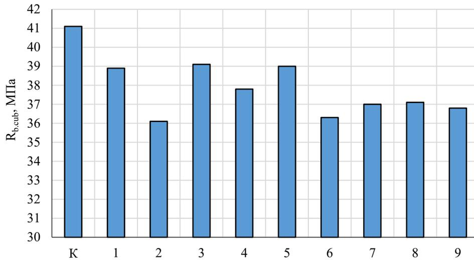
Рис. 2. Изменение прочности при сжатии облегченного бетона в зависимости от объёмных содержаний крупного и мелкого пористых заполнителей (К – контрольный состав; 1, 2...9 – опытные составы)
