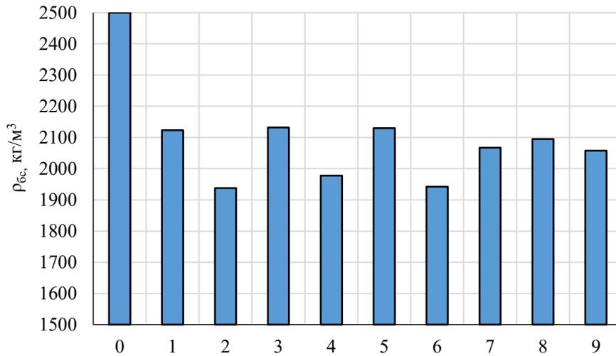
Рис. 1. Изменение плотности облегченного бетона в зависимости от объёмных содержаний крупного и мелкого пористых заполнителей (К – контрольный состав; 1, 2...9 – опытные составы)
