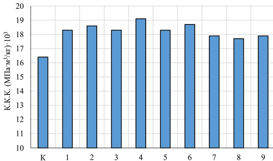
Рис. 3. Изменение коэффициента конструктивного качества облегченного бетона в зависимости от объёмных содержаний крупного и мелкого пористых заполнителей (К – контрольный состав; 1, 2...9 – опытные составы)
