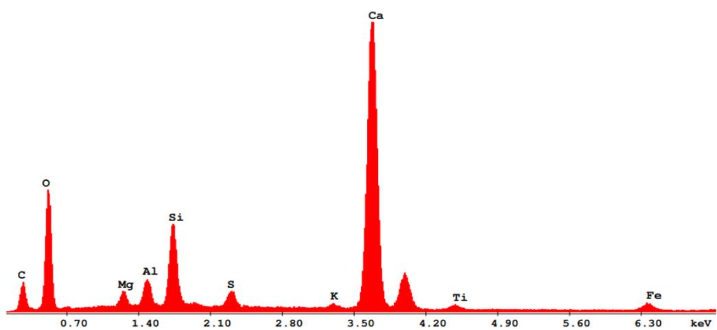
Рис. 4. Элементный микроанализ поверхности модифицированного цементного камня
